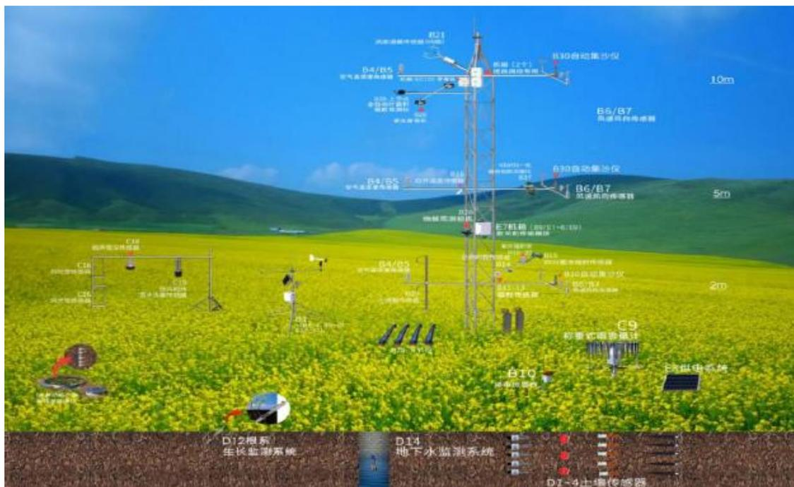
图 2-3 水循环观测场示意图
