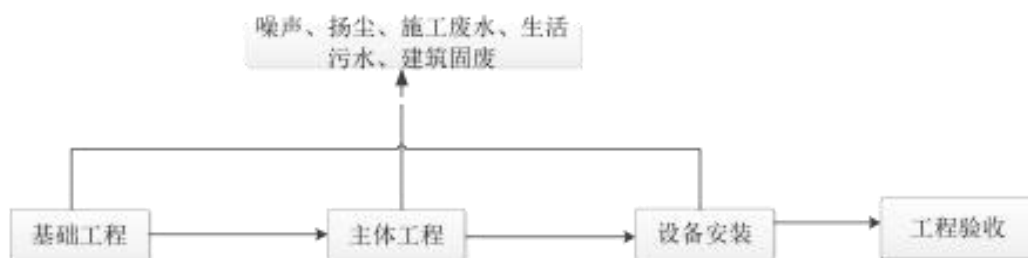
图3 施工期污染物工艺流程图
