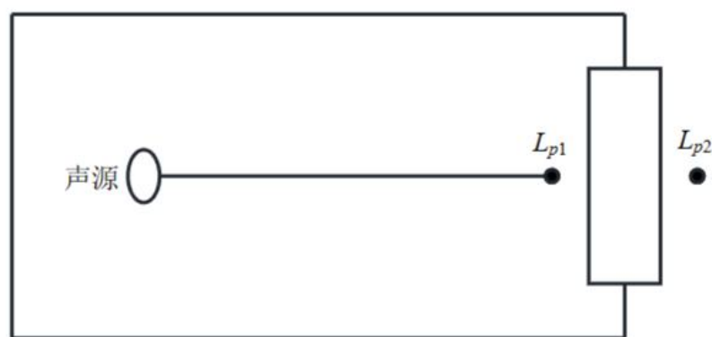
图 4-2 室内声源等效为室外声源图例
