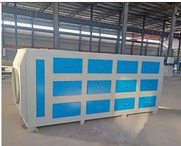
图 4-4 防火材料检测实验室活性炭吸附箱
